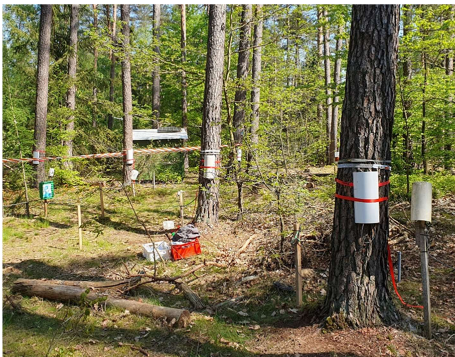
Abbildung 2.2.1-15: Saftfluss-Messbäume mit Strahlungsschutzschilden, die fünf Größenklassen repräsentieren, im Kiefernbestand. Im Hintergrund ist das mit Absperrband markierte ERT-Feld samt Messhütte zu erkennen.
