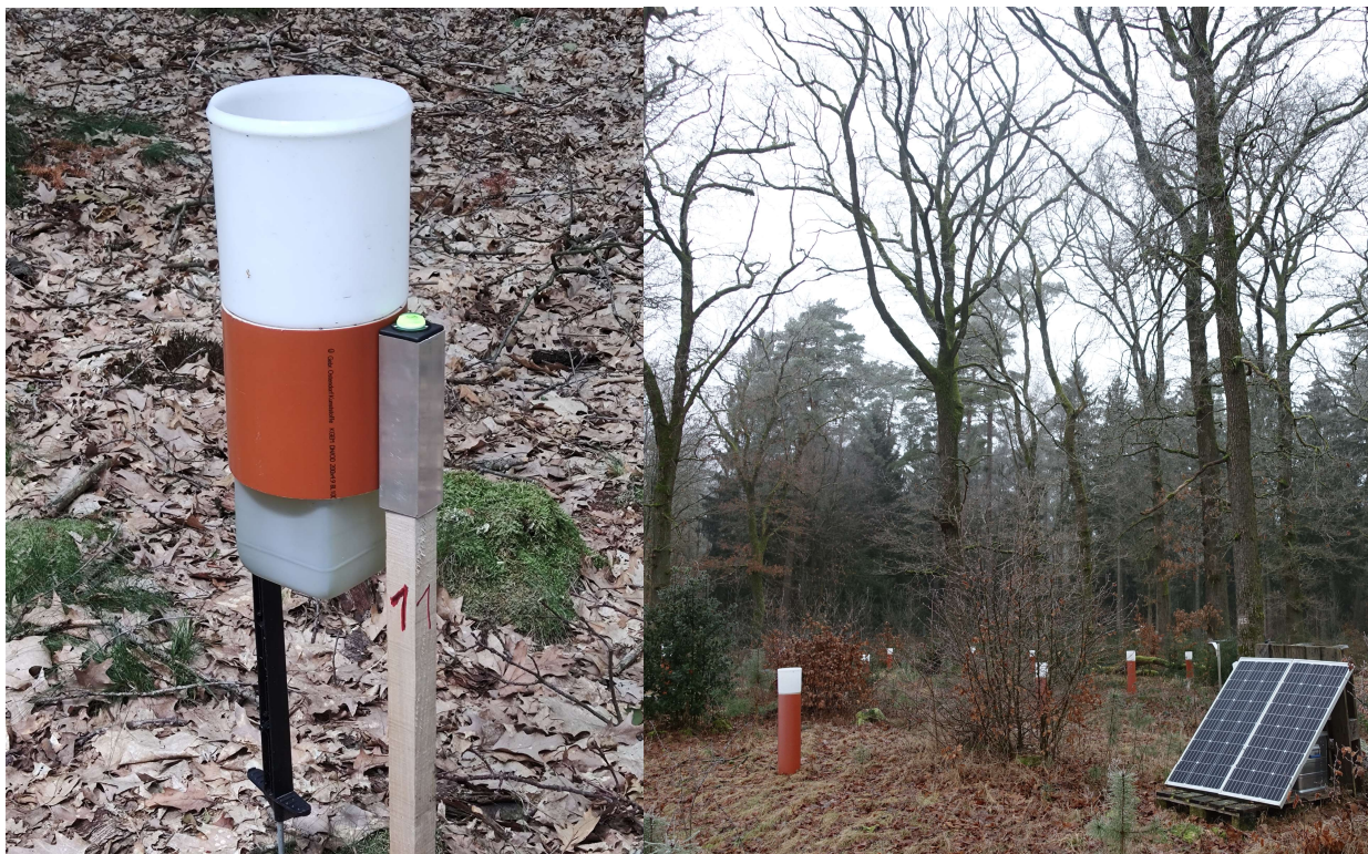
Abbildung 1.2.1-1: Versetzbarer, sog. Wandersammler (links) und einige der 21 feststehenden Kronentraufesammler an Punkten des 7m x 7m-Rasters auf der Stieleichenfläche (rechts).
